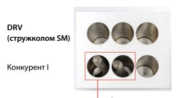
Режимы резания:  $V_{рез.} = 150$  м/мин,  $f = 0,08$  мм/об., диаметр обработки  $\varnothing 25$  (5D), глубина сверления 98 мм, с подводом СОЖ, заготовка: X5CrNi1810
