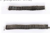
Масса стружки, производимой внутренней кромкой, на единицу длины (оценка компании-разработчика)
