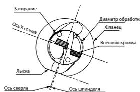
Рис. 4. Избыточное смещение (диаметр отверстия уменьшен)
