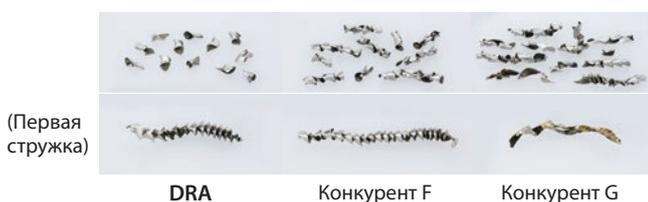
Режимы резания: Врез = 60 м/мин, f = 0,2 мм/об, диаметр обработки ø14 мм, глубина обработки = 70 мм, СОЖ
